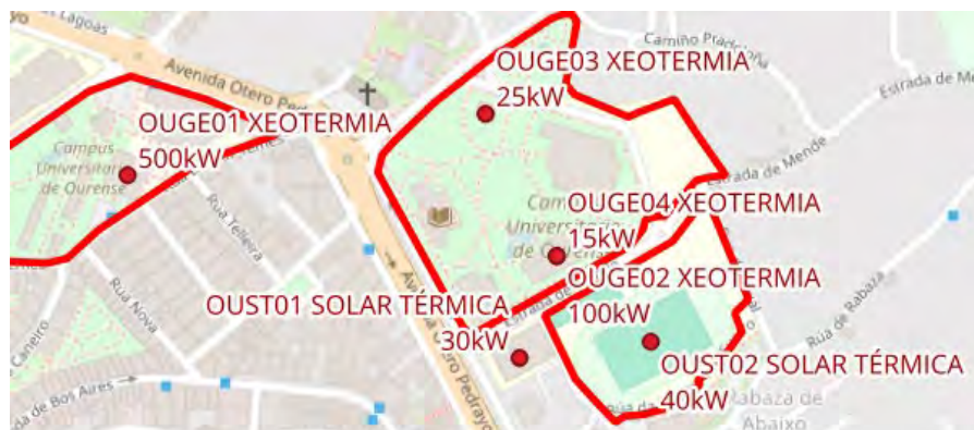
Ilustración 30. Instalacións renovables térmicas no campus de Ourense
