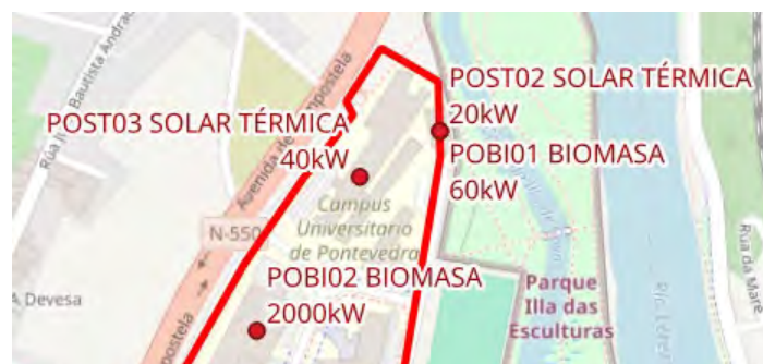
Ilustración 31. Instalacións renovables térmicas no campus de Pontevedra
